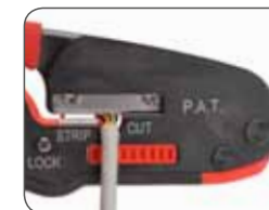
Зачистка круглого провода
