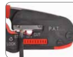
Зачистка плоского провода
