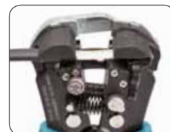
Снятие оболочки многожильного провода
