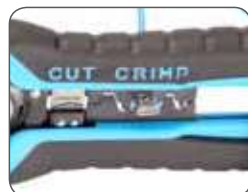
Опрессовка автоклеммы под двойной обжим
