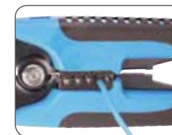
Опрессовка наконечника НШВ
