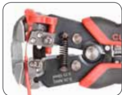
Снятие изоляции с проводов
