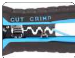
Опрессовка неизолированного наконечника
