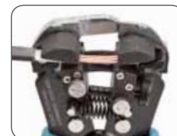
Одновременное снятие изоляции с трех проводов
