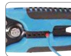
Опрессовка наконечника НШВИ
