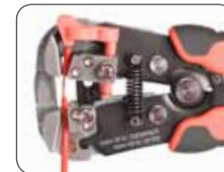
Снятие изоляции с проводов
