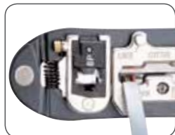
Зачистка плоского провода
