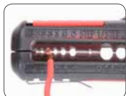
Снятие изоляции с проводов
