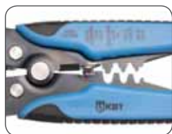
Опрессовка изолированного наконечника
