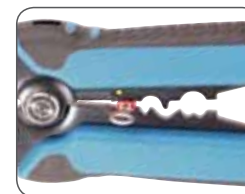
Опрессовка изолированного наконечника
