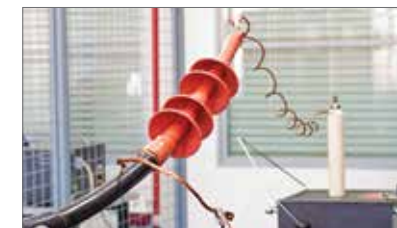
Высоковольтные испытания кабельных муфт
