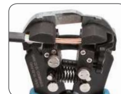
Одновременное снятие изоляции с трех проводов
