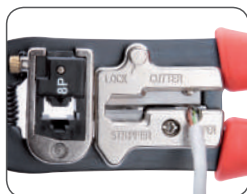
Зачистка круглого провода
