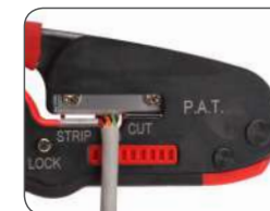
Зачистка круглого провода
