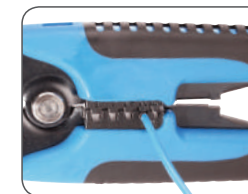
Опрессовка наконечника НШВ
