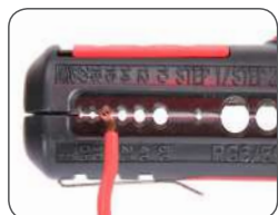
Снятие изоляции с проводов
