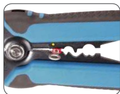
Опрессовка изолированного наконечника
