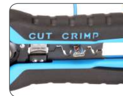
Опрессовка автоклема под двойной обжим
