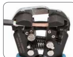
Одновременное снятие изоляции с трех проводов
